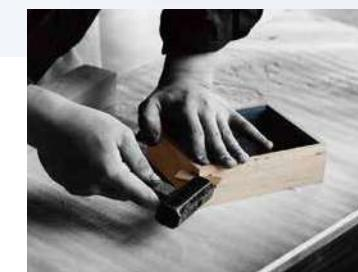
板同士の貼り合わせに強度をもたせるために、あらかじめ切った溝に別の板(扉の実)を打ち込みます。
