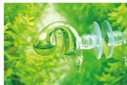
下坠球式测试器内的试剂需要每周更换。
