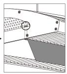
②カチッと音がして、本体側面外装の穴に ツメが掛かるまで取り付け部を確実に 差し込んでください。
